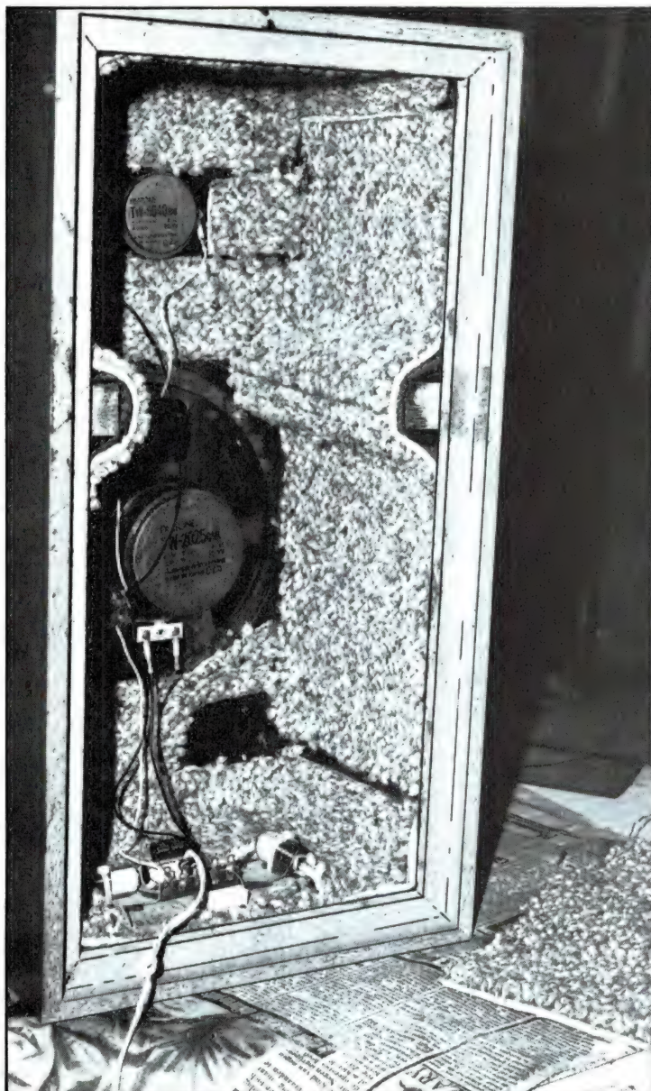
Afb. 9. De slotfase is klaar: over de lagen dakleer zijn oude stukken hoogpolig tapijt aangebracht.
